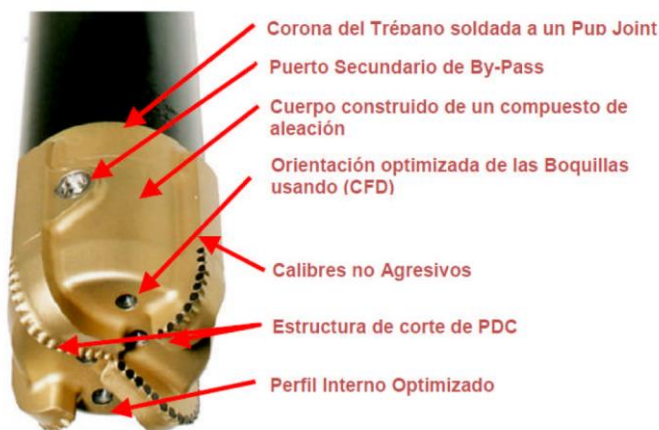
Figura 4. Características del diseño mecánico de la zapata.
