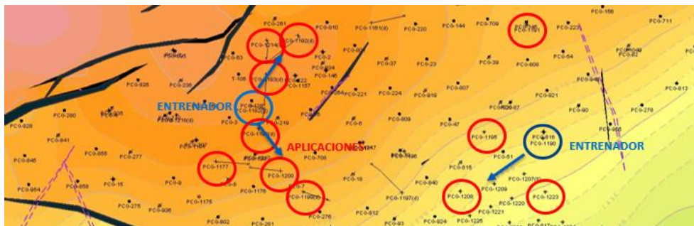
Figura 10. Planeamiento de desarrollo in fill con pozos entrenadores (en azul) propuestos estratégicamente para la expansión de pozos de aplicación (en rojo).
