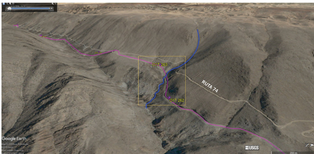
Figura 2. Ubicación del proceso erosivo en el contexto regional de la Puna (recuadro amarillo). El gasoducto faldea a media ladera izquierda de un gran valle fluvial que se observa en la fotografía. En azul desarrollo del curso de agua implicado en la formación del cañón de erosión.
