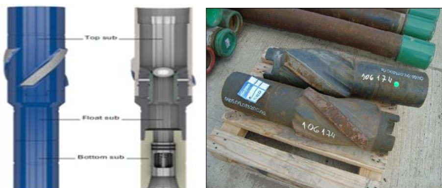
Figura 7 – Dispositivo de suelta de trépano y estabilizadores - Proyecto Piloto Año 2008
