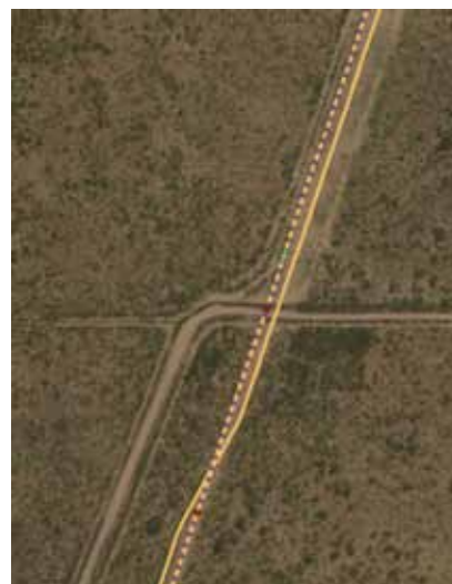
Figura 10. En este caso se puede ver que si algunos de los defectos quisieran ser verificados debería intervenir la zona de camino. Superponiendo la capa de Tapadas es posible estimar la excavación que se realizará.
