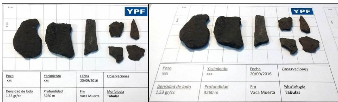
Figura 3. A la izquierda derrumbes tabulares, a la derecha fotografía adquirida en diagonal para apreciar el poco espesor de los derrumbes tabulares.
