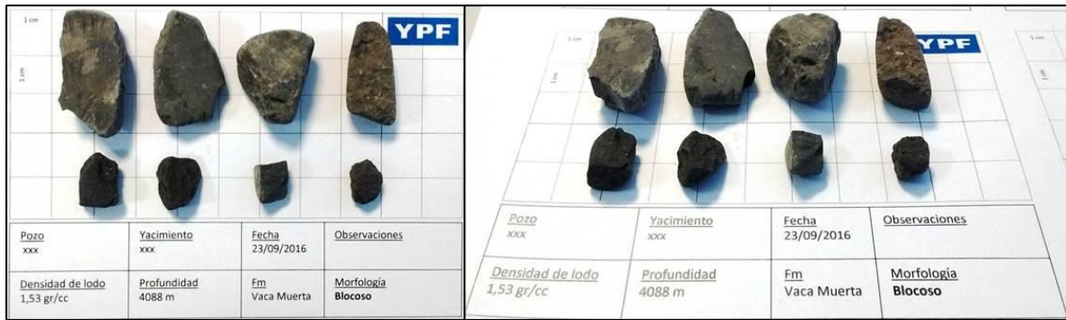
Figura 4. A la derecha derrumbes tipo blocosos y a la izquierda fotografía toma en diagonal para apreciar el buen desarrollo en las tres dimensiones de los derrumbes blocosos; se identifican caras pseudoparalelas y planos que se intersectan a 90^\circ .
