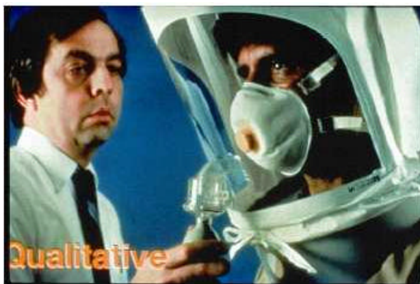
Figura 2: Prueba de ajuste con sacarina
