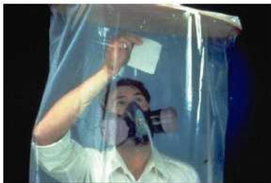
Figura 1: Prueba de ajuste con acetato de isoamilo (aceite de banana)
