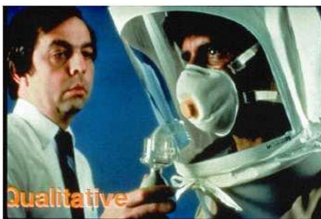
Figura 3: Prueba de ajuste con Bitrex
