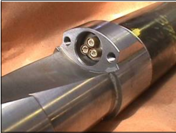
Figura N° 17 – Motor 375 con cabeza 450
