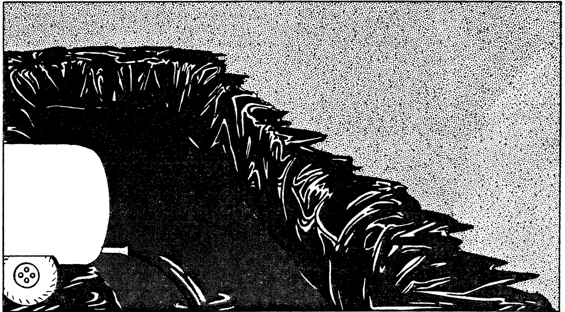
Figura 7. Foso forrado de plástico para el almacenamiento temporal de mezclas de hidrocarburo/agua.
