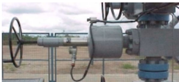
Figura 1: Válvula de seguridad de subsuperficie (VSS) con actuador neumático
