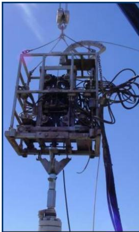
Figura 6. Cabeza de inyección de cadenas.
