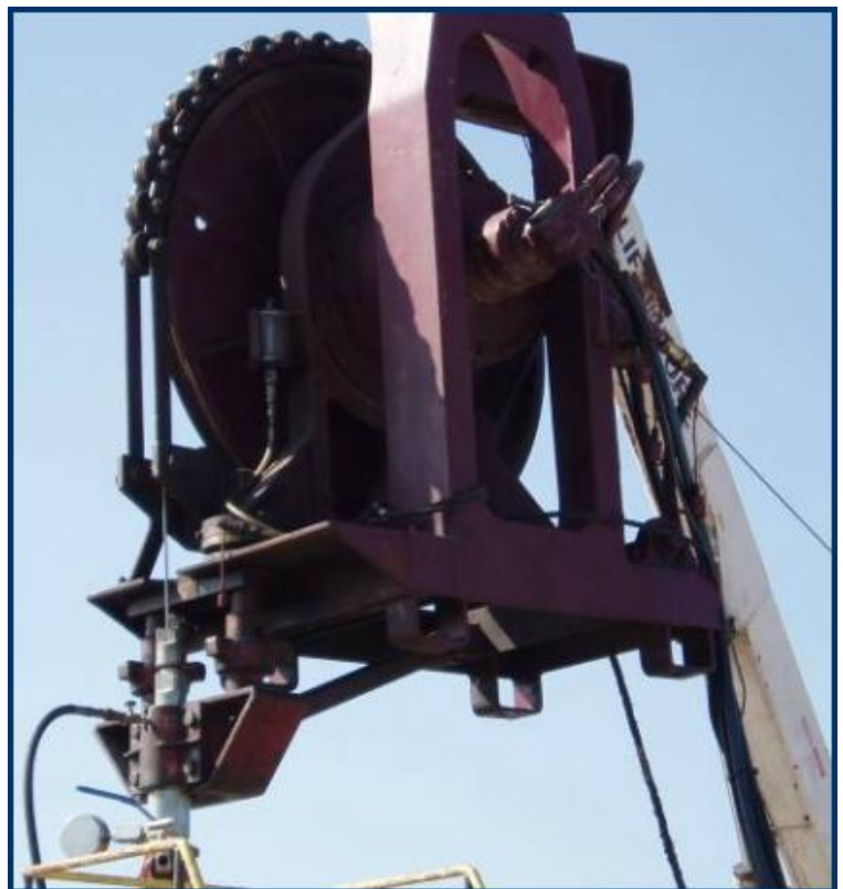
Figura 7. Cabeza de inyección de rueda.
