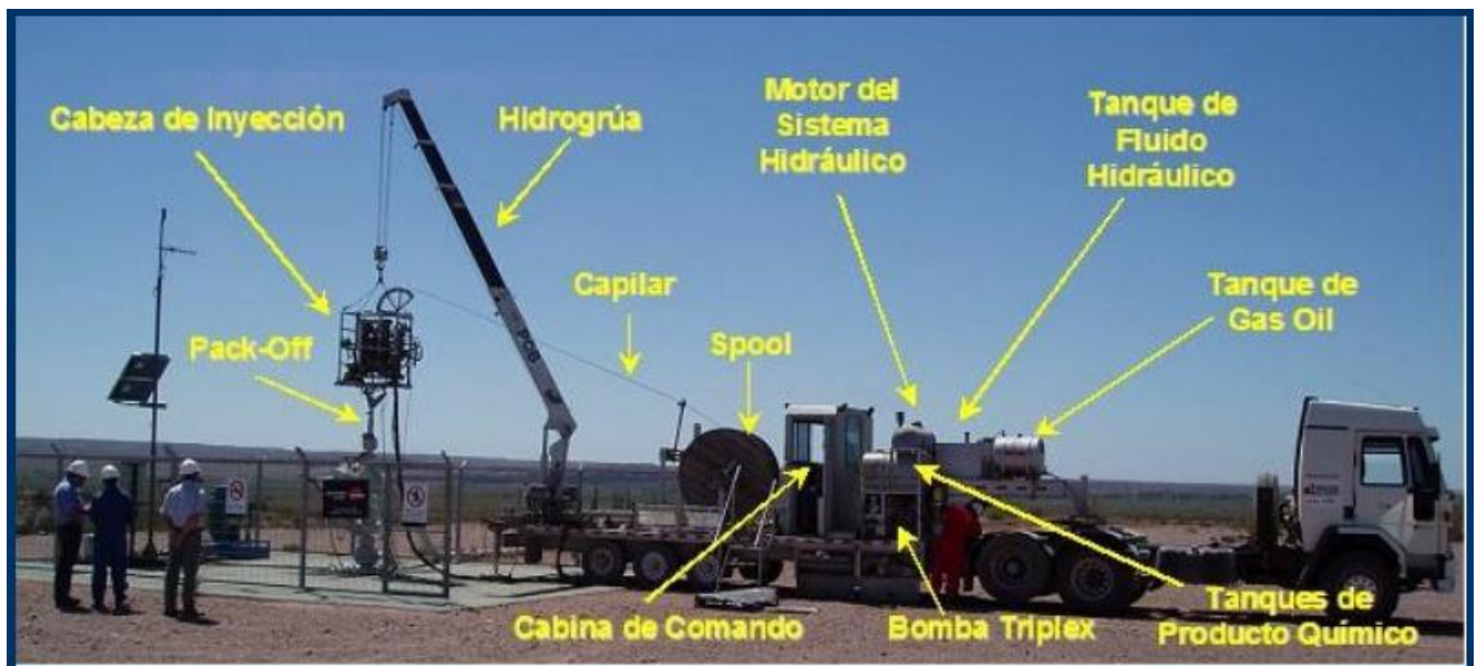
Figura 5. Partes constituyentes de la unidad especial de coiled tubing.
