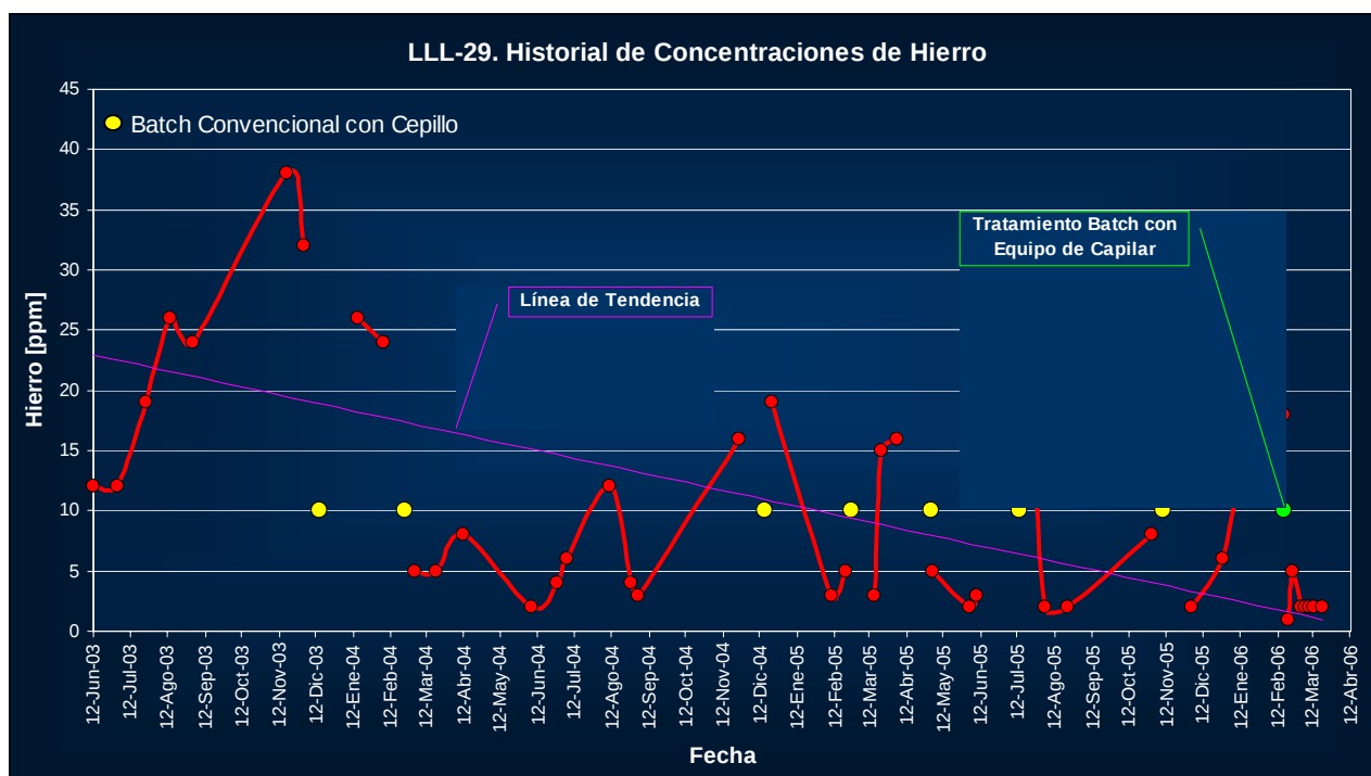
Figura 12. Resultado del tratamiento con inhibidor de corrosión en el pozo LLL-29.
