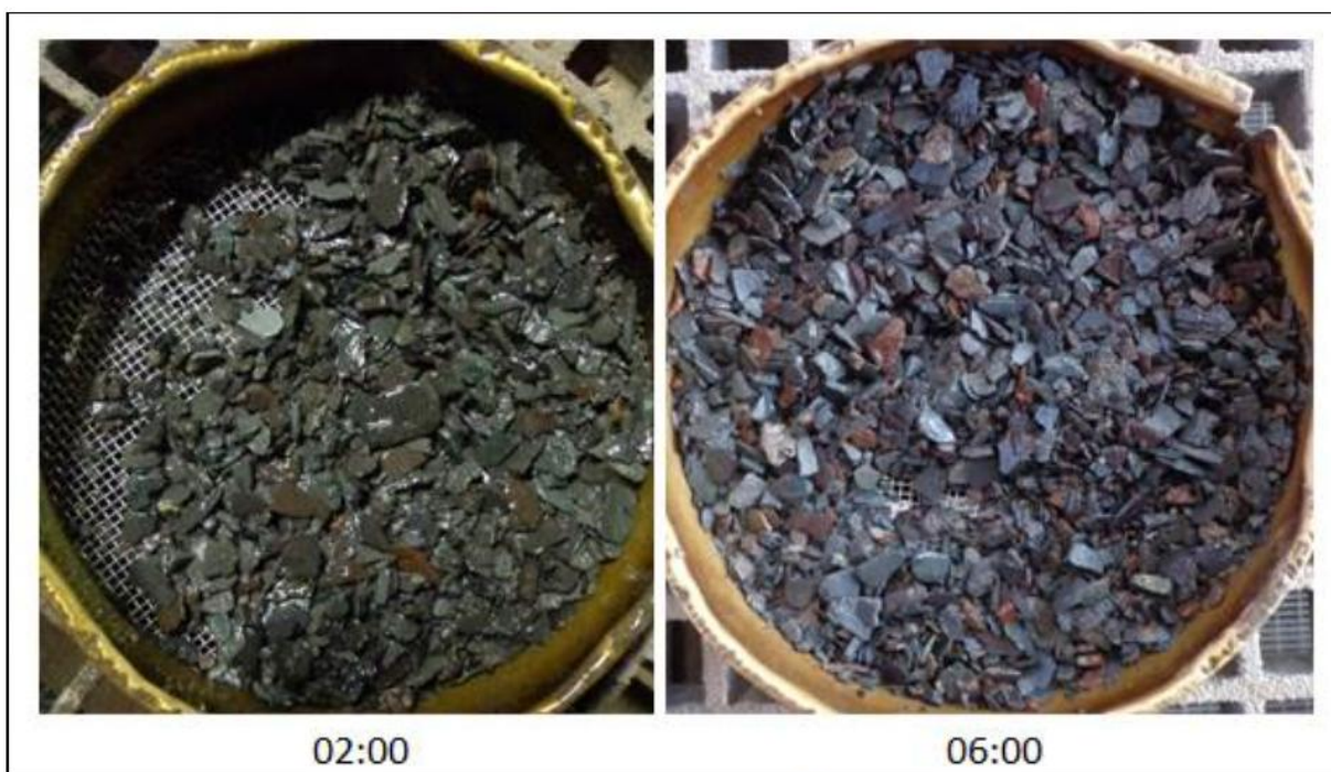
Figura N° 12 - Derrumbes durante la maniobra de calibre luego de perforar Fm Lajas Inferior
