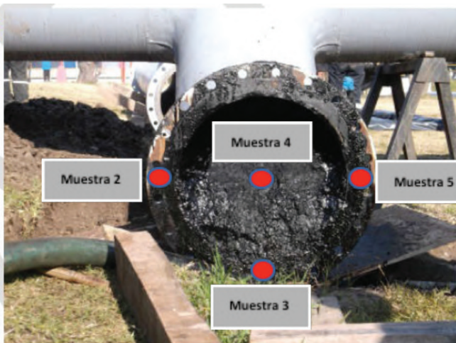
Figura 5. Hidrocarburo negro viscoso que filtra del niple de 24" durante los trabajos de desconexión en el accesorio T (izquierda); residuo de hidrocarburo de donde se extrajeron las muestras 2, 3, 4 y 5 (derecha).
