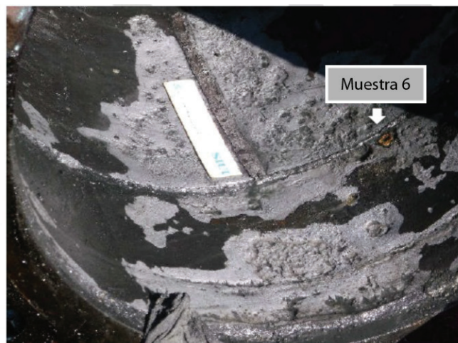
Figura 6. Clusters de corrosión localizada observados en la parte inferior de la brida de conexión de la línea. Se indica la ubicación de la Muestra 6, que es un depósito encontrado dentro de la perforación descubierta.
