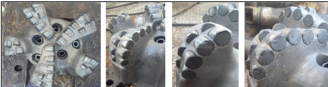
Figura 10. Parámetros aplicados en fase intermedia de El Orejano y condición del trepano PDC al finalizar la fase.
