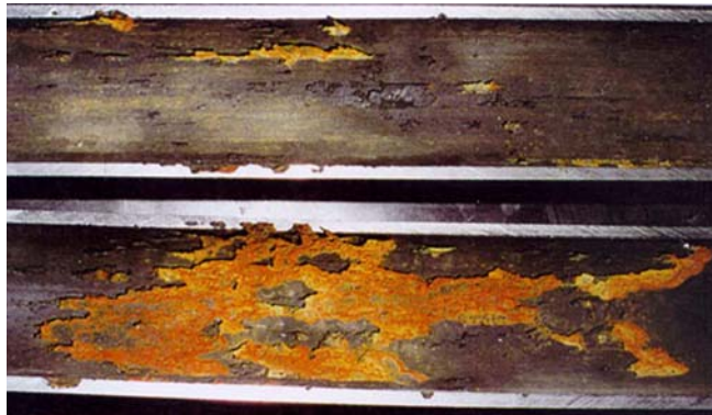
Foto 1: “Mesa attack” en Tubing 3 ½” N-80 luego de un Workover en LLLata
