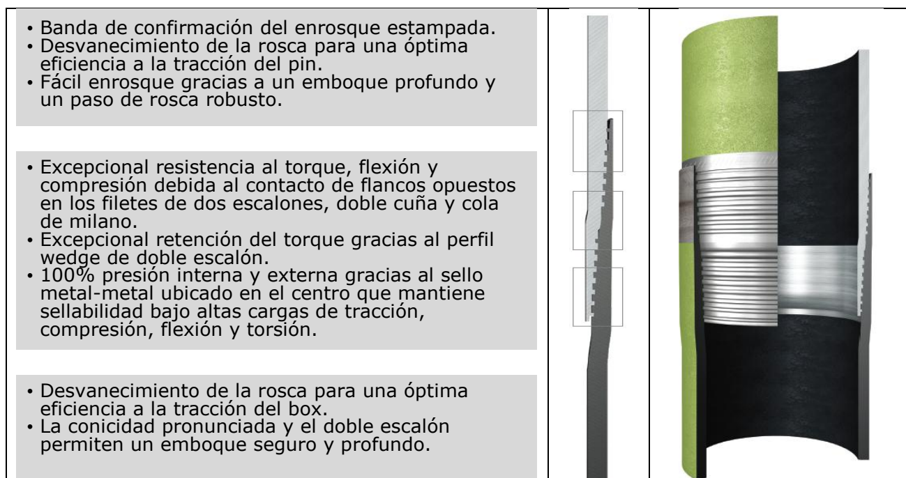
Figura 2: Conexión Premium, semiflush con rosca tipo "wedge"
