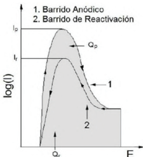
Figura 2. Curva esquemática del método DL-EPR (ISO 12732).
