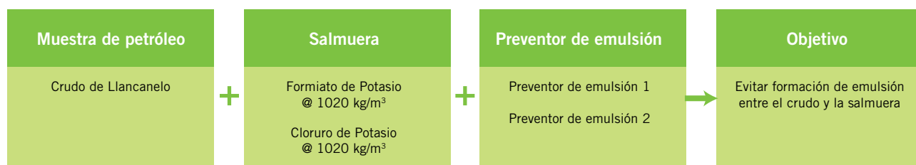
Figura 7. Esquema general del ensayo de emulsión.
