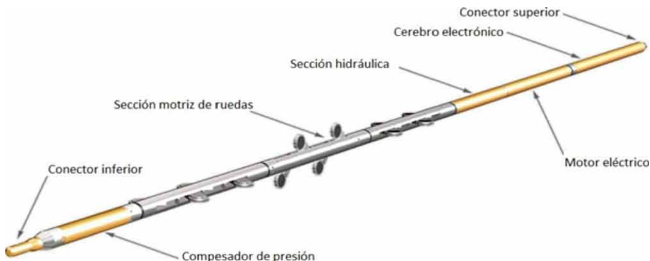
Figura 7. Elementos que conforman tractor para cable eléctrico.
