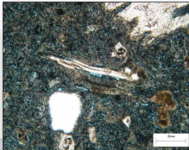
Microfisuras parcialmente ocluidas conformando microbrecha
