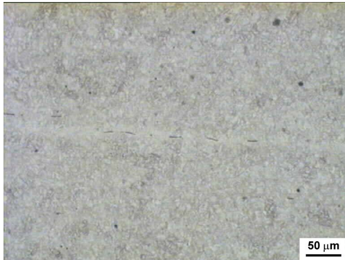
Fig.7 Detalle del bandeo
