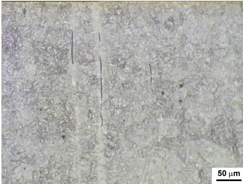
Fig.1 Bandeado del material
