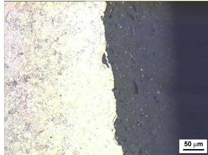
Fig.10 Capa decarburada y oxido adherido
