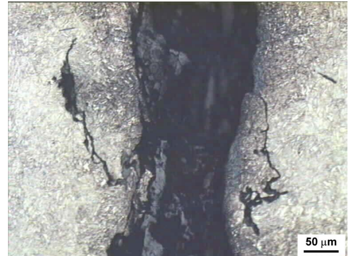
Fig.4 Avance de la fisur. en forma intergranular
