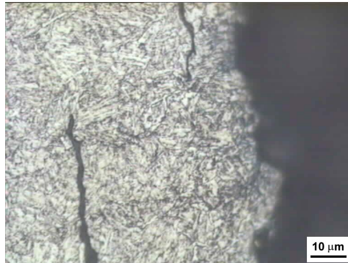
Fig.15 Detalle de la propagación
