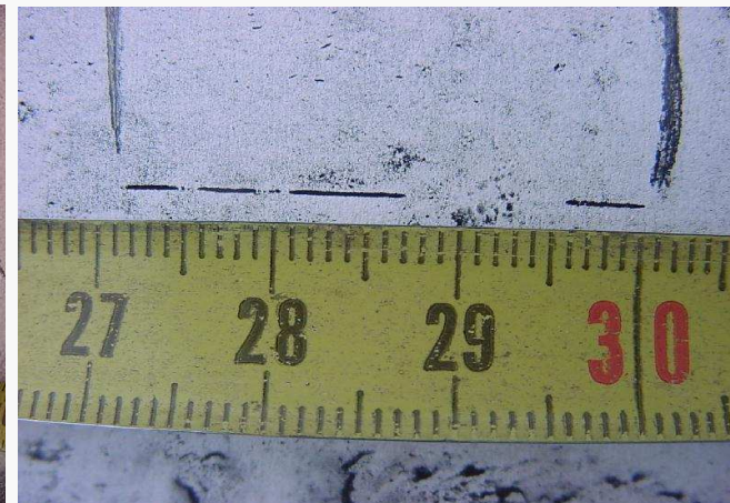
Falta de Fusion Longitud 46 mm Profundidad 1,2 mm
