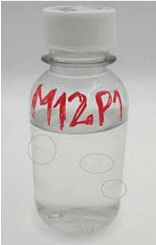
Figura 21. M12 P1: Mezclas de bruta M12, solución de poliacrilamida (2500 ppm) y producto.
