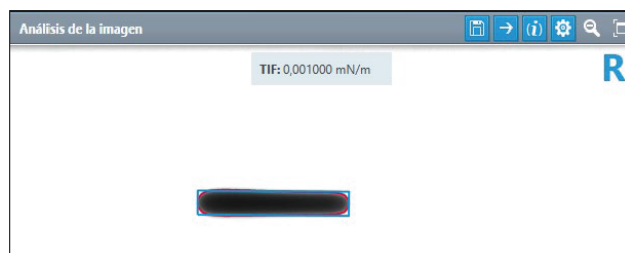
Figura 9. Medición de tensión interfacial de crudo en solución de polímero-surfactante Rocksweep .
