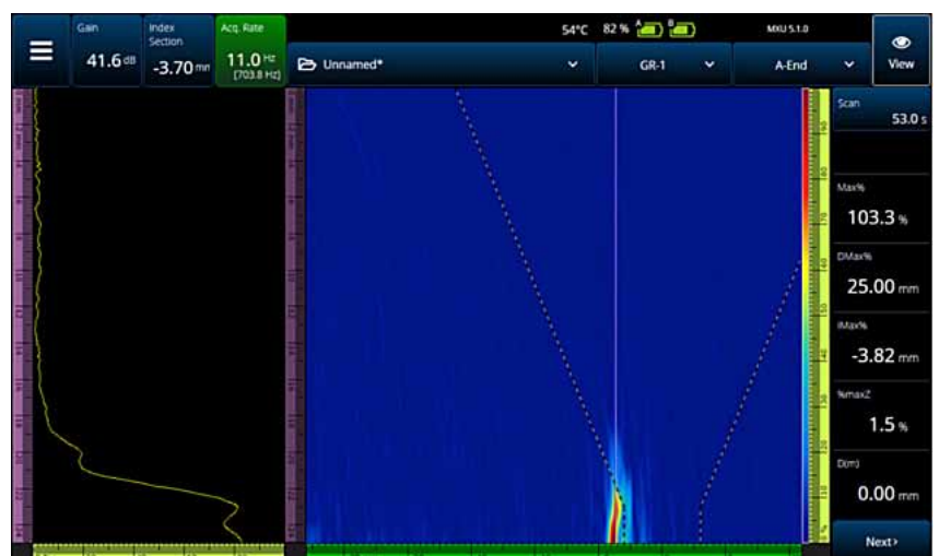
Figura 18. Fisura detectada por TFM (modo de onda 3T).
