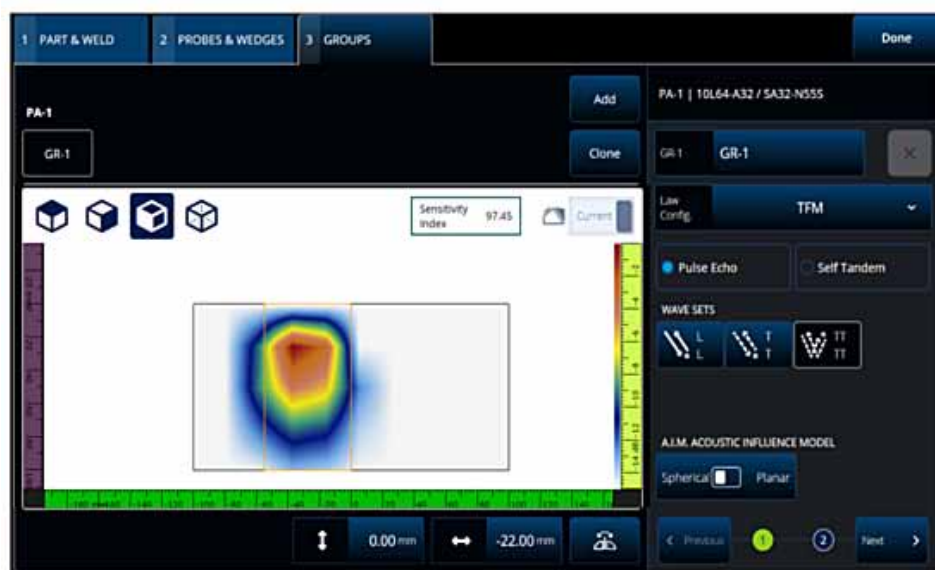
Figura 12. Ejemplo de simulación en Mapa de Influencia Acústica (AIM) (izquierda) e imagen real de inspección (derecha).
