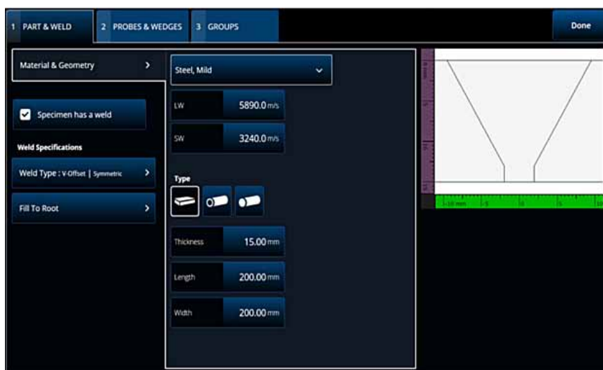
Figura 8. Elaboración de plan de escaneo, geometría y tipo de material por inspeccionar.
