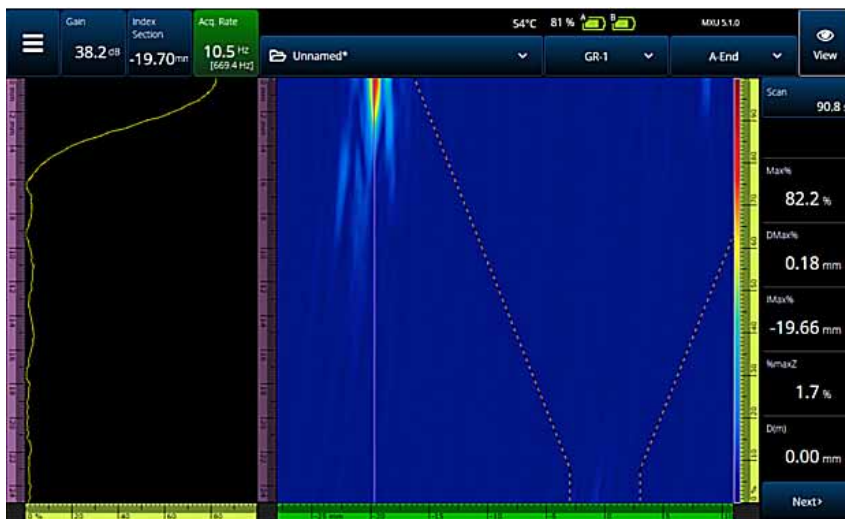
Figura 22. Fisura detectada por TFM (modo de onda 5T).
