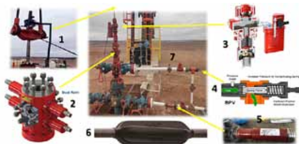
Figura 21. Componentes principales de un bombeo mecánico en shale oil .
