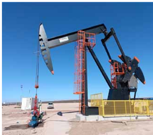
Figura 22. Unidad de bombeo mecánico Modelo Maximizer (Weatherford).
