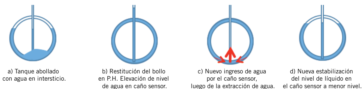
Figura 9. Evolución del nivel de agua en la doble pared en las distintas etapas de la falla.
