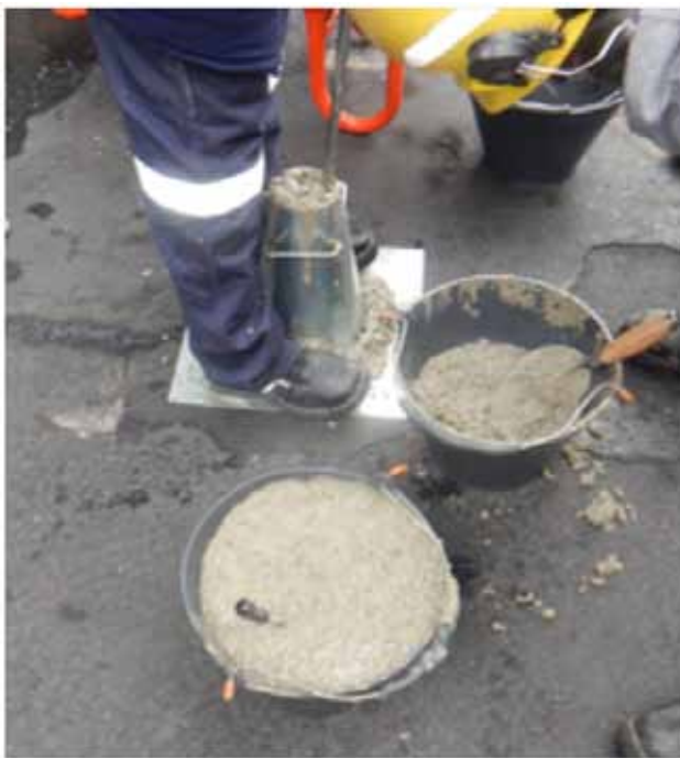
Figura 23. Fotografía de ejecución de probetas.
