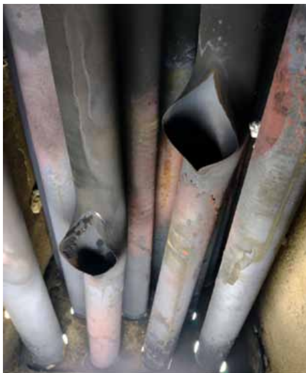
Figura 5. Fallas encontradas en los tubos de la zona convectiva.
