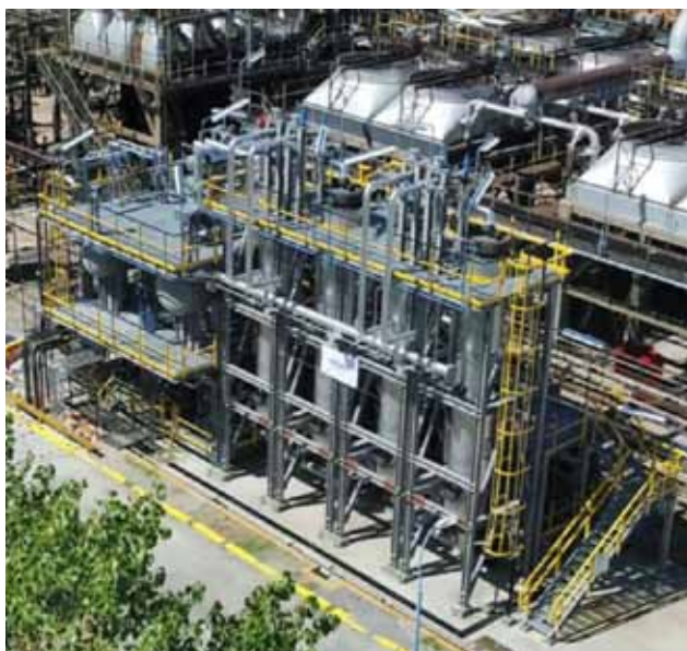
Figura 17. Planta modular de producción de propelente (PFU).
