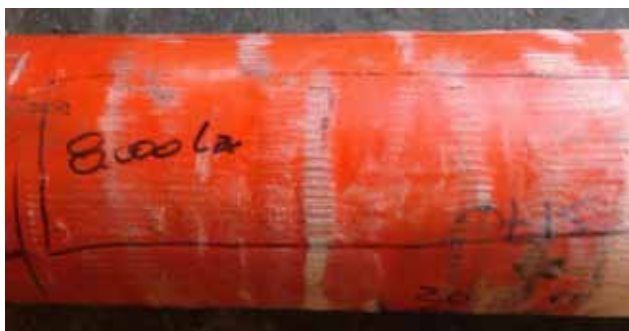
Figura 11. Muestra ensayada con 8000 lb/ft de torque.
