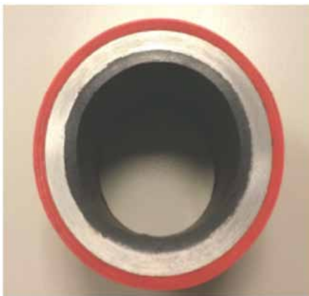
Figura 1. Corte de tubing revestido interior/exterior.
