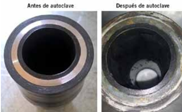
Figura 6. Encamisado interno antes y después de autoclave (45 °C, 140 bar, 24 h) 100% en contacto con HCL (15%) y HF (5%).
