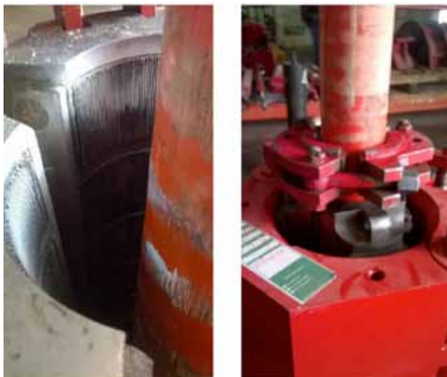
Figura 10. Prueba con cuña Spider con mordazas para cromo.
