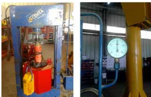
Figura 13. Prueba de agarre con prensa hidráulica.
