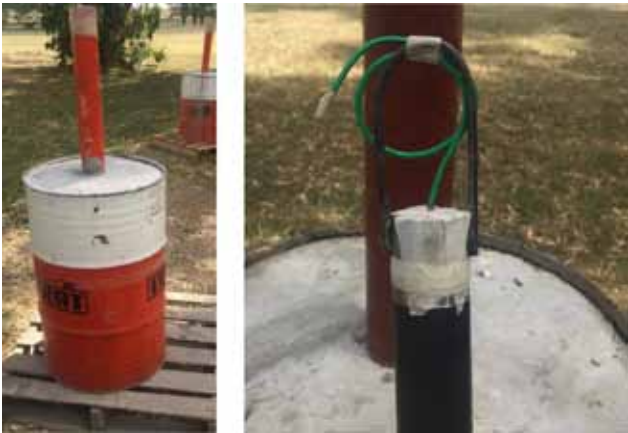
Figura 7. Detalle de la probeta y gancho se sujeción del cañón.
