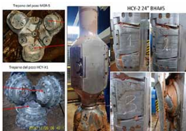
Figura 5. Componentes desgastados en pozos de correlación. ROP Perdida de conos de brocas tricónica y desgaste prematuro de los PAD del RSS, debido a formaciones abrasivas.
