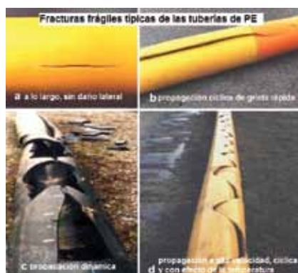
Figura 2. Fracturas frágiles típicas de tuberías de polietileno: a) a largo término, sin daño lateral; b) propagación crítica de grieta, rápida; grieta dinámica con de material, espesor de pared grueso; d) grieta "running crack", propagación a muy alta velocidad, comportamiento cíclico y frágil con efecto de latemperatura. Extraído de Reliability index computation for HDPE pipe using critical stress intensity factor . Kamel CHAOUI a, Latifa ALIMI a,b, Salaheddine AZZOUEZ. 23ème Congrès Français de Mécanique Lille, 28 Août au 1er Septembre 2017.
