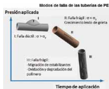
Figura 4. Esquema ilustrativo de la falla de tuberías de PE presurizadas con el tiempo.
