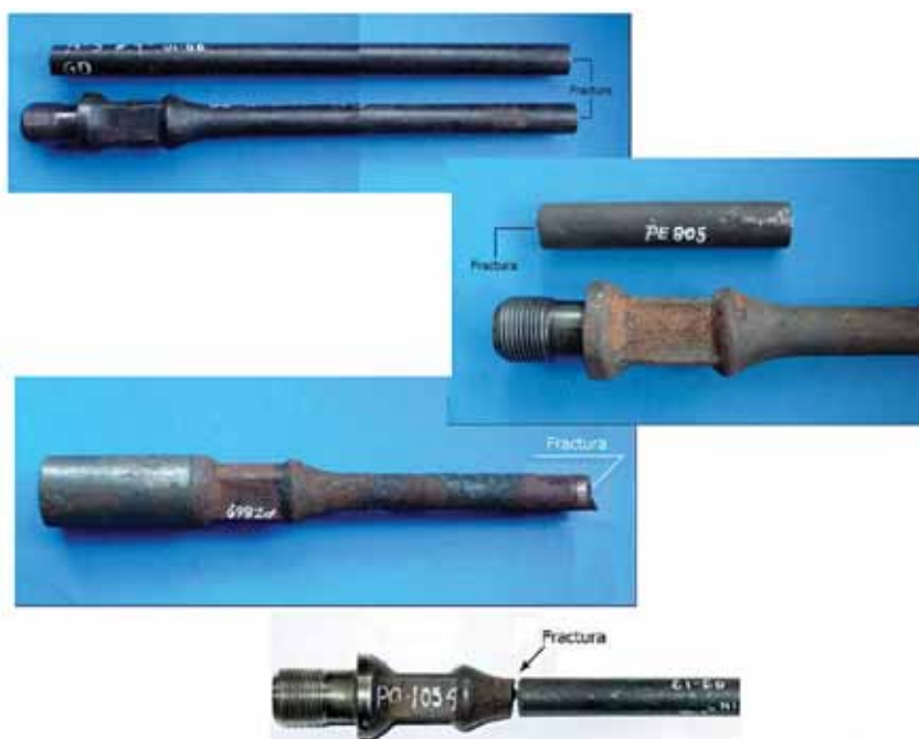
Figura 3. Ubicación de fallas en varillas de bombeo.
