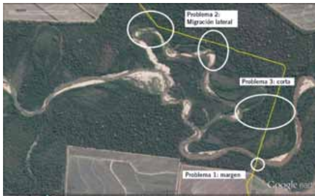
Figura 2. Cruce del Río Santa María. Cruce construido con una traza tangente a los meandros.
