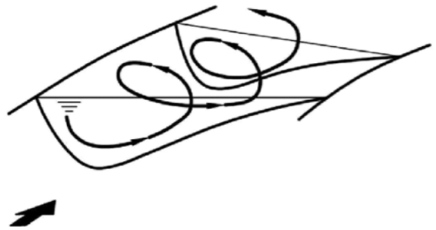
Figura 5. Flujo helicoidal resultante.
