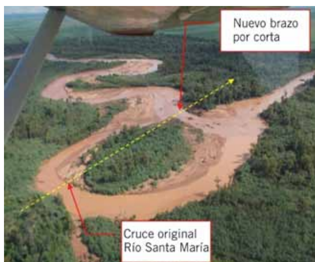
Figura 22. Cruce del Río Santa María. Corta natural del meandro después del cruce especial.
