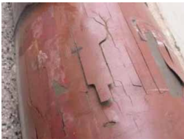
Figura 26. Muestra 1, posensayo. Debonding del coating caño B debido a la deformación plástica.
