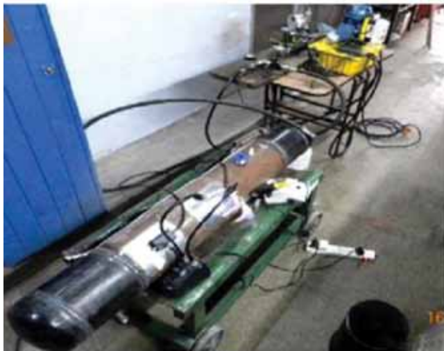
Figura 22. Armado de los cabezales con virolas e instrumentación. Izquierda, modelo del ensamble con el estado tensional residual previo al ensayo.
