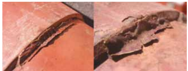
Figura 6. Remanentes de resina epoxi del embonamiento en el borde de junta del lado 1B.
