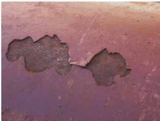
Figura 4. Desprendimiento de coating , pit y raspones en el cuerpo de la muestra 1.
