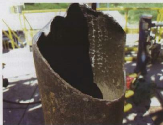
Figura 4. Rotura de tubería por debilitamiento de pared debido a erosión causada por fractura.
