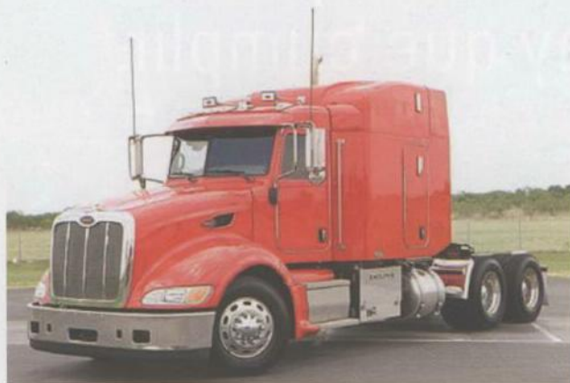
Camión de Peterbilt Motors Company con el sistema SOFC como unidad de potencia auxiliar (APU) desarrollada por Delphi e instalada. Puede verse la unidad APU plateada (caja) en el centro de la parte inferior del camión.
