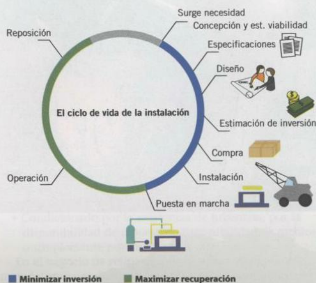
Figura 7. Concepto y evolución. El ciclo de vida de una instalación
