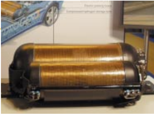
Tanque de H_2
