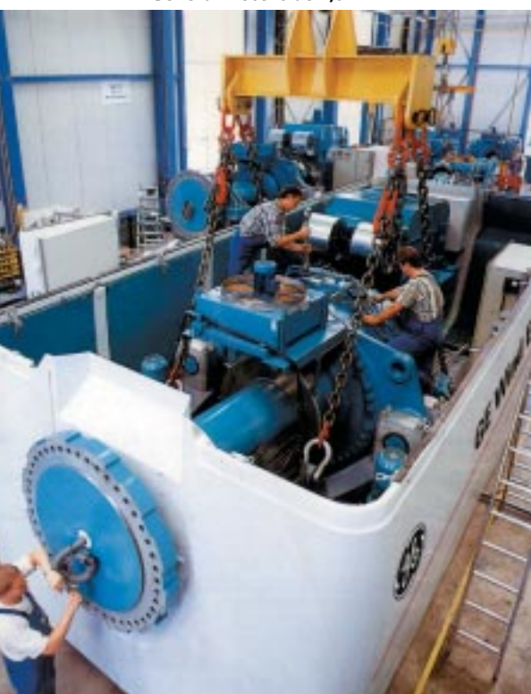
Figura 6 • Interior de la barquilla de la turbina General Electric de 1,5 MW.
