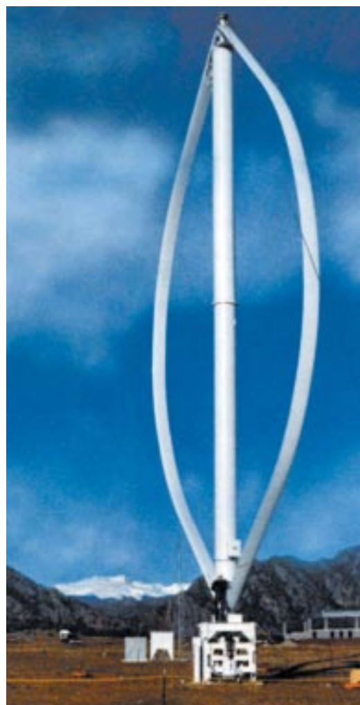
Figura 3• Turbina de eje vertical tipo Darrieus
