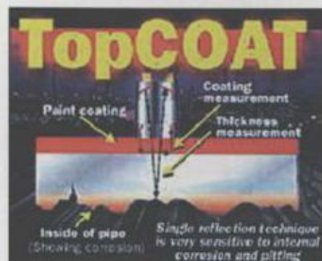
Figura 6. Mecanismo de medición con la técnica TopCOAT, ideal para cañeros con corrosión.
