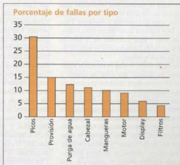
Figura 4. Distribución de fallas en equipos dispensers y surtidores (tiempo: 6 meses).
