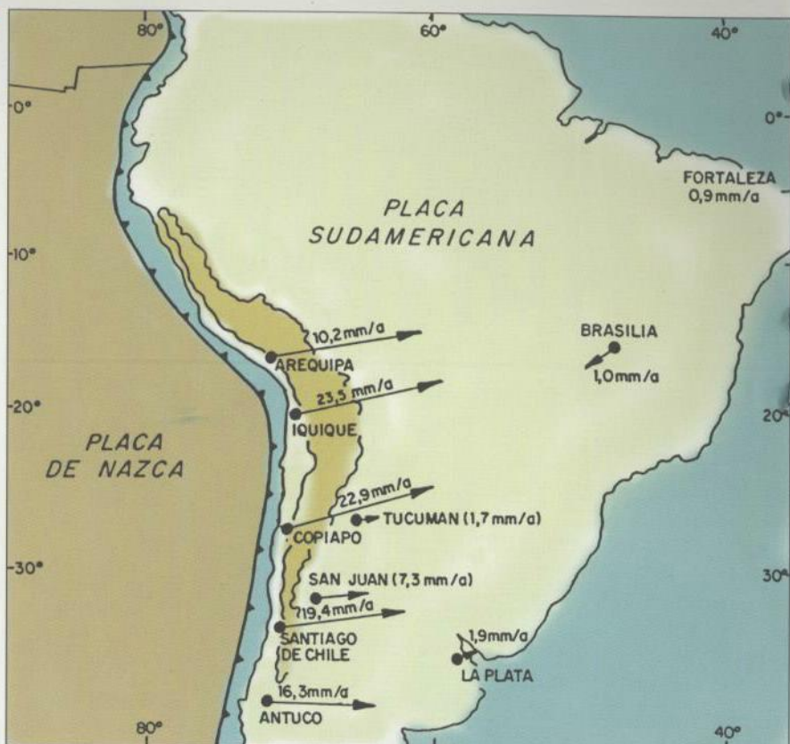
Figura 3. Valores de acortamiento medidos por GPS en los últimos tres años en estaciones de observación continua. Los vectores de velocidad media anual (mm/a) tienen como patrón de referencia el cratón sudamericano fijo (basado en Kendrick et al., 1999).
