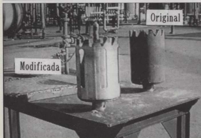
Fig. 12 TROZO EXTRAIDO DEL REGENERADOR
