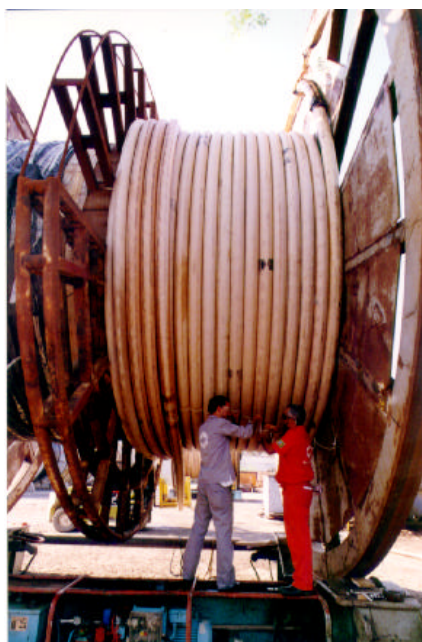
Figura 2 - Linha flexível em sua bobina de armazenamento.
