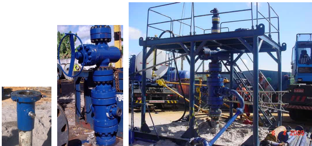
Figura 3. Redução e cabeça de trabalho dedicada, individualmente e conectadas para operação
