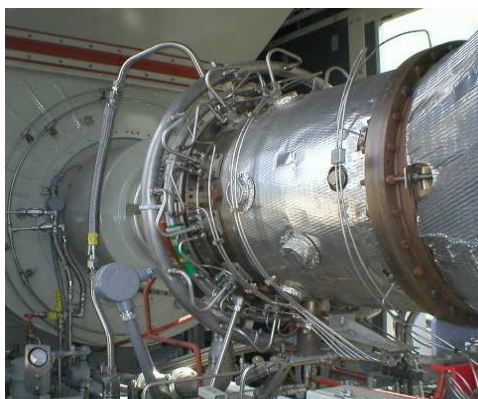
Figura 1.2 – Ilustração da distribuição dos sensores na câmara de combustão das Turbinas TAURUS 60.
