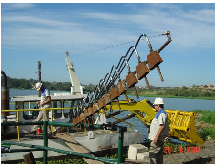
Figura 7. Fixação do suporte dos queimadores na embarcação.
