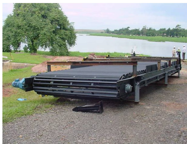
Figura 10. Vista geral da esteira metálica para coleta de plantas aquáticas. Início do processo de instalação.
