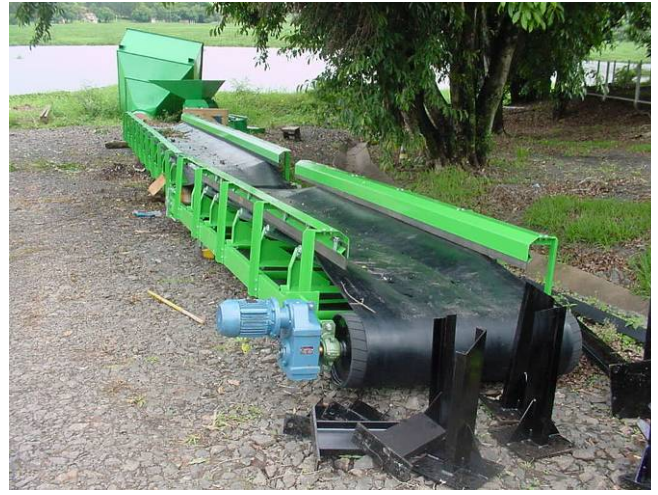
Figura 12. Conjunto de esteiras transportadoras de borracha posicionadas antes e após o picador.
