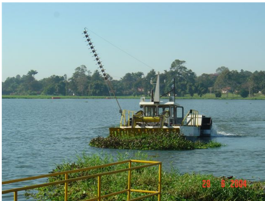
Figura 8. Embarcação navegando no reservatório com o sistema de controle por fogo já instalado.
