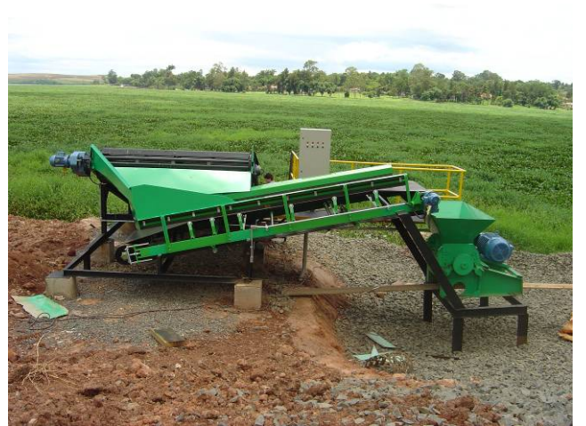
Figura 14. Esteira para coleta de plantas aquáticas, esteira transportadora, picador e painel de controle.
