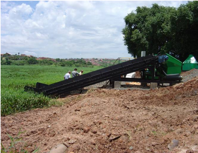
Figura 11. Vista geral da esteira metálica para coleta de plantas aquáticas.
