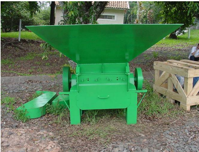
Figura 13. Componentes do picador e motor utilizado para acioná-lo.
