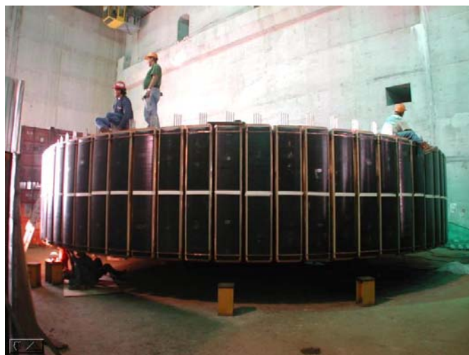
Figura 1: Rotor de la Unidad Generadora N°1 de Caruachi
