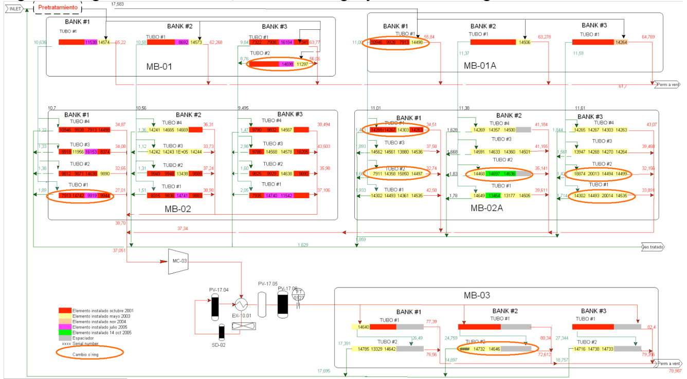
Figura 13. Seguimiento de sistema, detección de fugas y cambio de o-rings.
